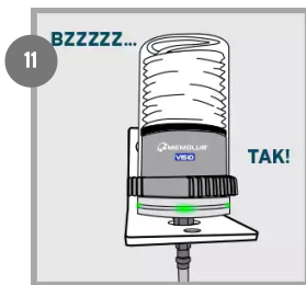
11 VISIO initialiseert, knippert elke kleur aan en voert één uitdrijving uit. Groene lampjes bevestigen de normale werking.
